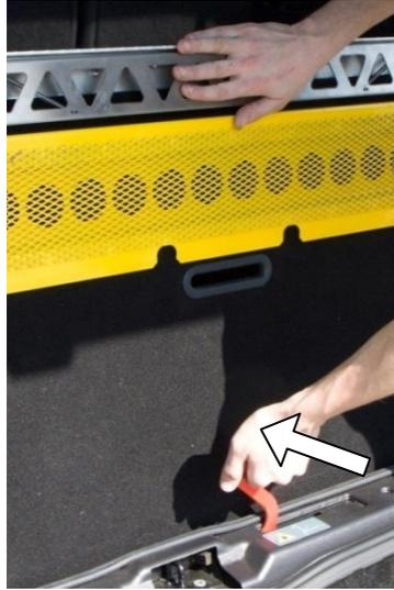
Ziehen Sie den linken Hebel der Rampe, damit ist die Rampe für das Umklappen entriegelt.
