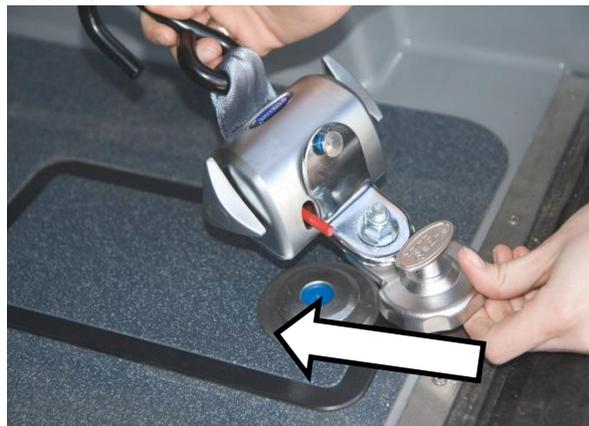
Befestigen Sie die hinteren Schnellspanngurte auf dem Boden des Fahrzeugs in der Richtung des Pfeils.
