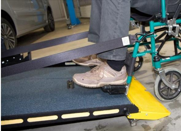
Die Haken nur am stabilen Rahmen befestigen! Nicht an abnehmbaren Fußstützen einhängen!
