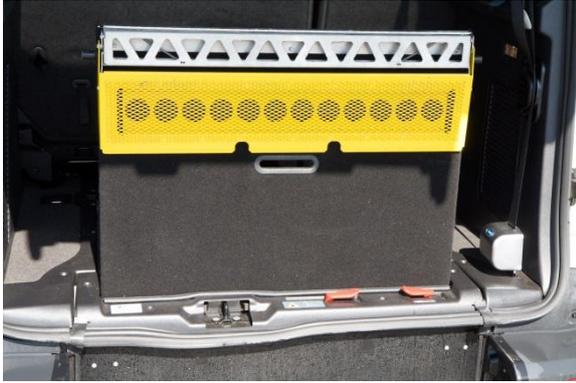
Heben Sie die Rampe in eine senkrechte Position an, so dass die seitlichen Riegel richtig zufallen. Klappen Sie das gelbe Signalblech an.
