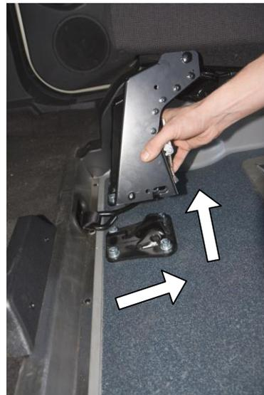
Schieben Sie den Fuß nach hinten und montieren Sie ihn ab.
