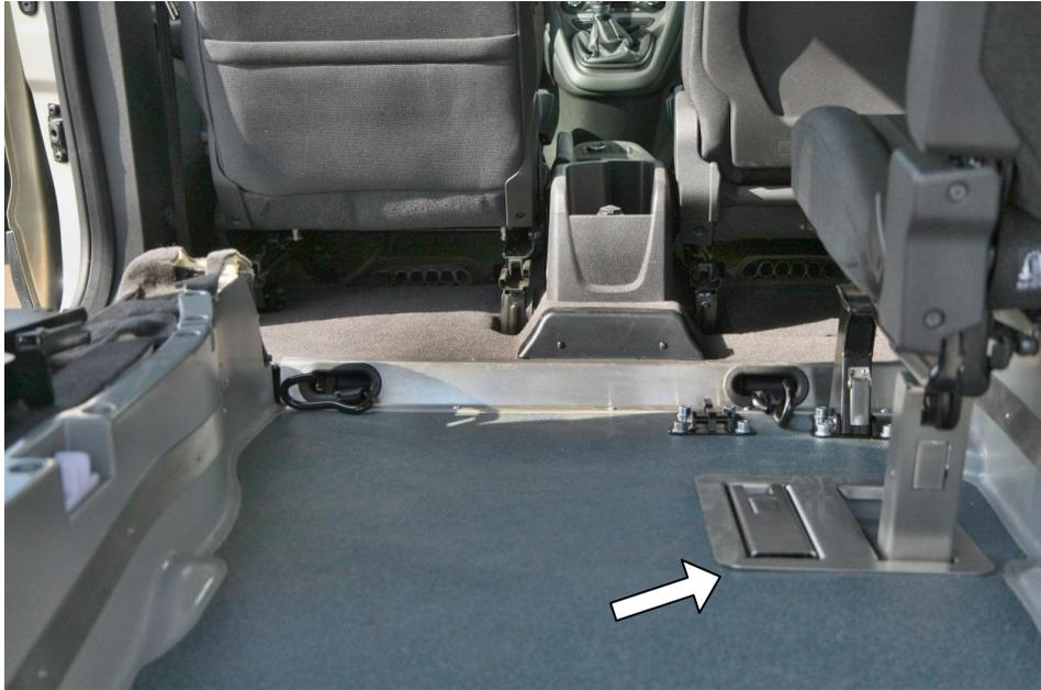
Legen Sie den hinteren linken Doppelsitz um. Bei elektrischen oder andersartigen schweren Rollstühlen auch den Einzelsitz. **Alternativ ist es auch möglich**, diese Sitze aus dem Fahrzeug komplett auszubauen (siehe auch Betriebsanleitung Ford). Beachten Sie, dass die hinteren Sitzstützen eingeklappt werden müssen, **bzw. bei normaler Nutzung immer ausgeklappt sein müssen, damit die Sitzbank einrasten kann und damit fixiert wird.**
