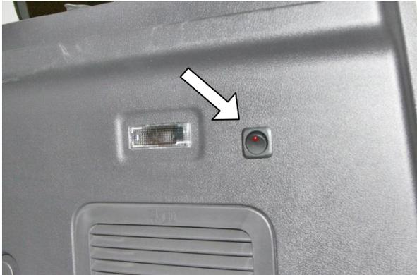
Die vorderen Gurte zur Sicherung des Rollstuhls sind mit einer elektrischen Sperre gesichert. Bevor Sie ziehen, betätigen Sie den Schalter. Die Lampe des Schalters leuchtet und damit werden die Gurte für das Herausziehen freigegeben.
