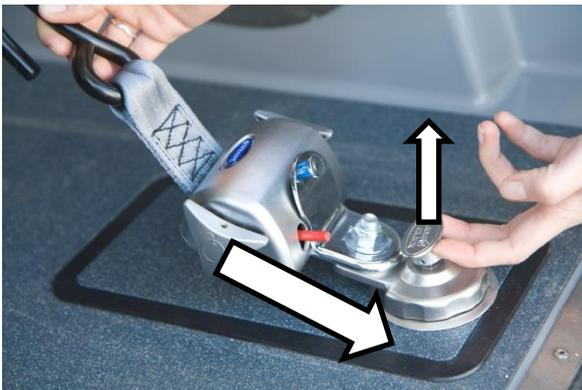
Die Demontage des Retraktors erfolgt durch hinaufziehen der Arretierung und abziehen von der Bodenscheibe.
