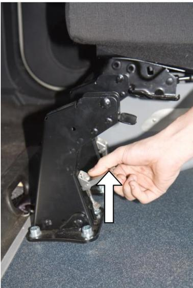
Entsperren des Sicherungsmechanismus zum Ausbau des Sitzes.
