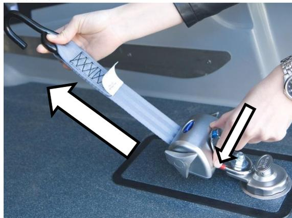
Herausziehen des Gurtes (falls erforderlich, den roten Entriegelungstift betätigen).
